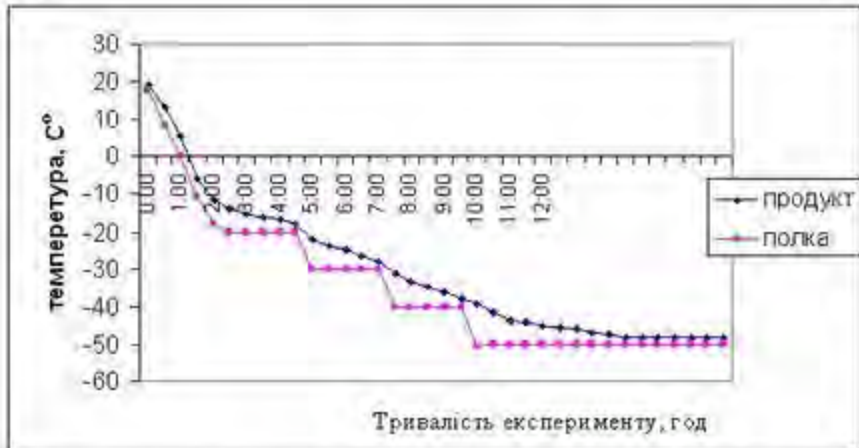
Рис. 3.3. Кінетична крива повільного заморожування розчину на основі ОБ.
