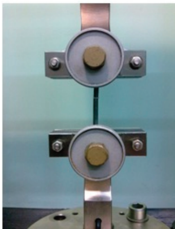
Рис. 15. Закріплена експериментальна модель в універсальній випробувальній машині TIRAtest-2300 на розтягнення
