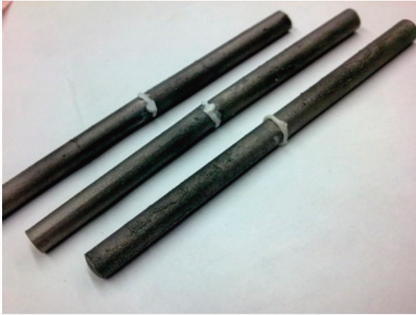
Рис. 13. З'єднані деталі за допомогою склоіономерного цементу Fuji Plus (Японія)
