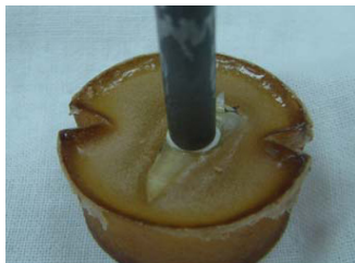
Рис. 1. Заготівля довжиною 40 мм і діаметром 5мм 2 з кобальто-хромового сплаву зацементована за допомогою Fuji Plus (Японія) до підготовленої поверхні зуба в залежності від методики підготовки
