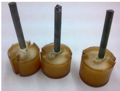
Рис. 19. З'єднані деталі за допомогою склоіономерного цементу Fuji Plus (Японія)
