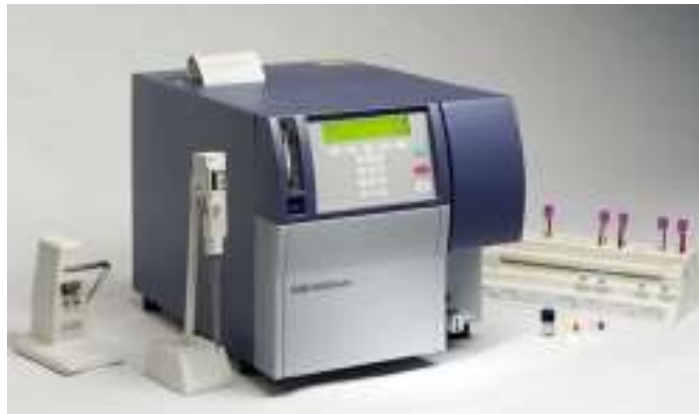
Рис. 2.2. Проточний цитофлюориметр FACS scan фірми Vector Diskinson (США).
