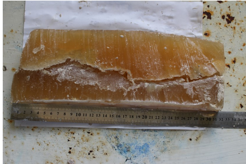
Рис. 2.9. Розпил желатинового блоку вздовж ходу ранового каналу після пострілу з автомату АК-74 (калібр 5,45 мм)
