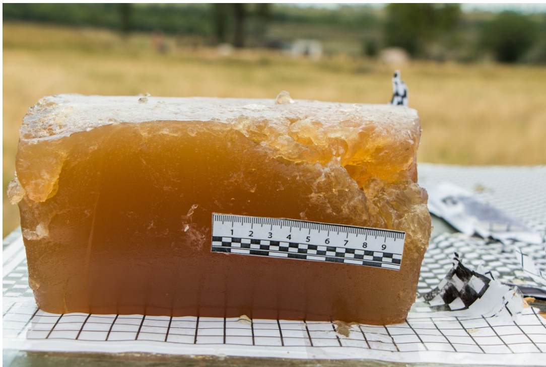
Рис. 2.4. Блок желатину після пострілу з АК 74, калібр 5,45 мм
