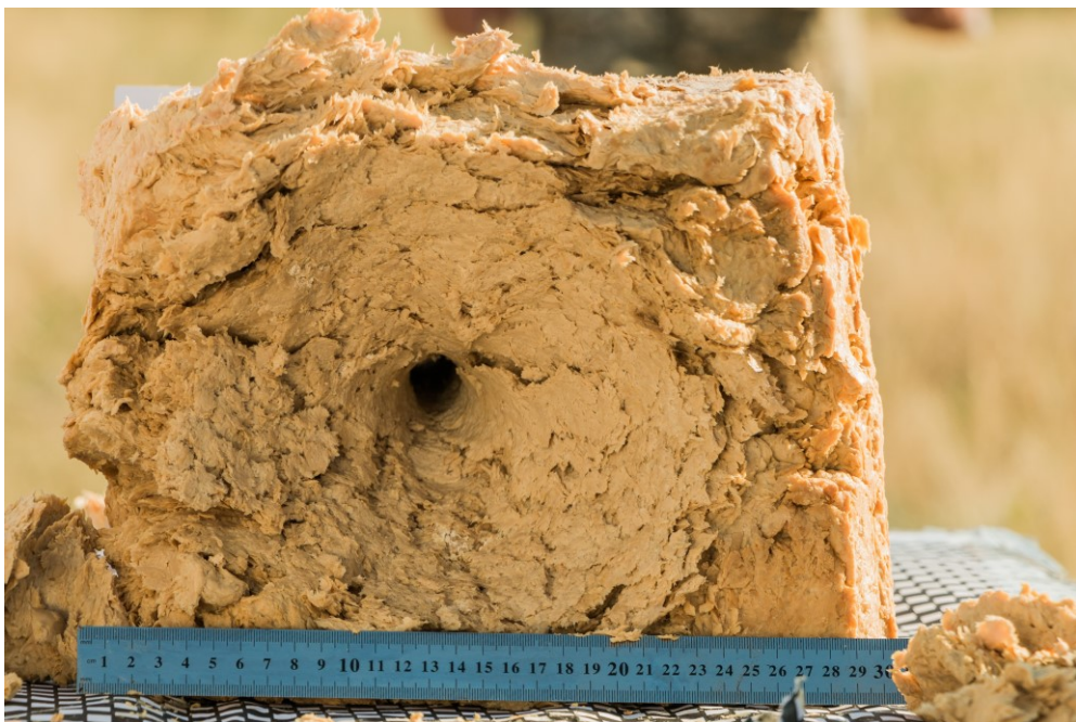
Рис. 2.6. Блок балістичного гліцеринового мила після пострілу АКМ калібр 7,62 мм
