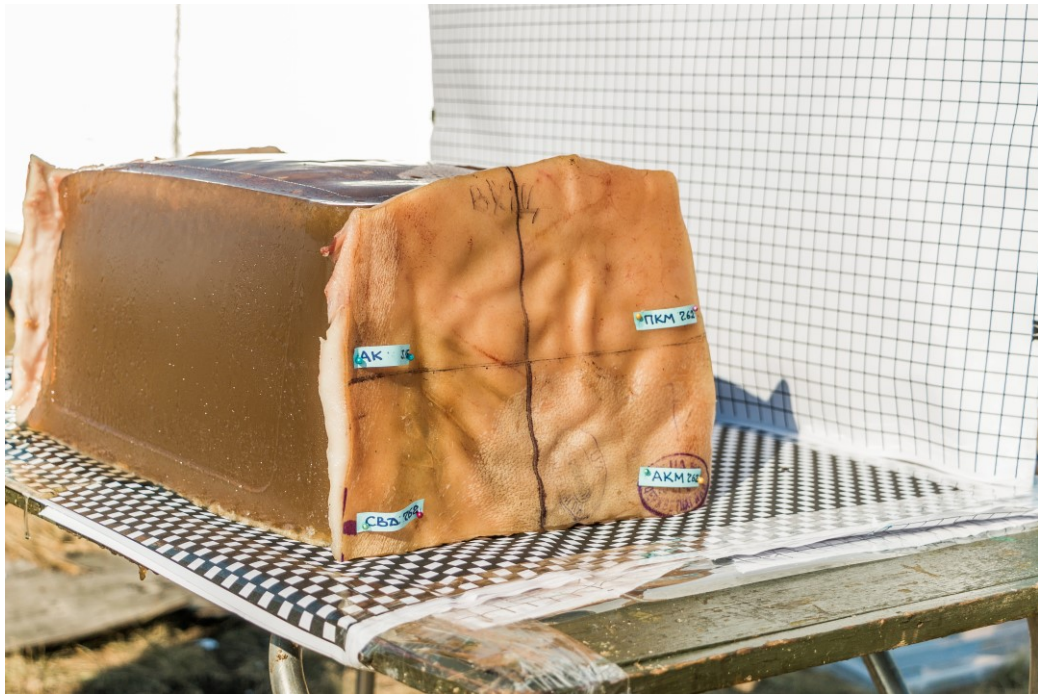
Рис. 2.5. Блок желатину із закріпленими на бокових поверхнях шматками свинячої шкіри
