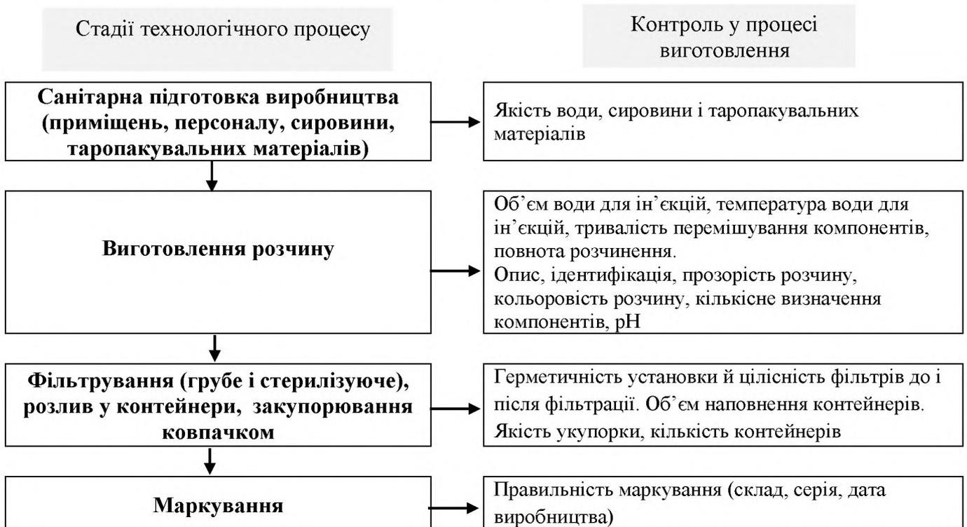
Рис. 4.1 Технологічна схема виготовлення лабораторних серій рідких кислотних концентратів для ГД
