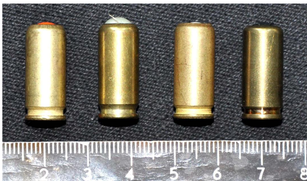
Рис. 6.2. Загальний вигляд патронів «АЕ 9», «Терен 3» та «Терен 3ФП»
