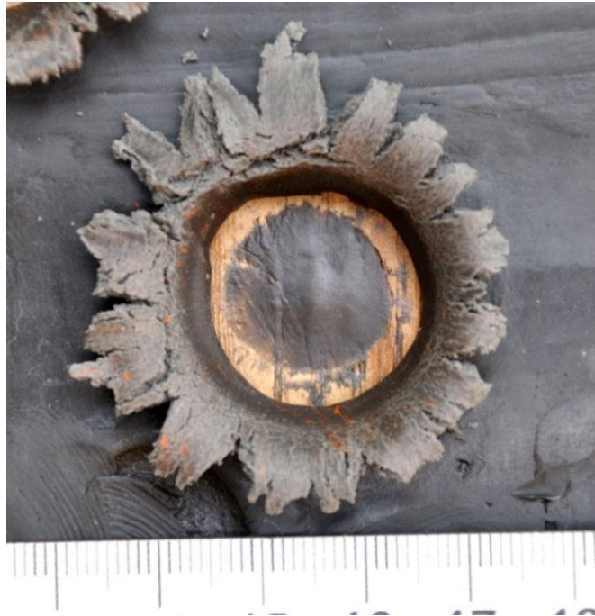
Рис. 4.1. Загальний вигляд утвореного пошкодження пластиліну при пострілі еластичним снарядом з дистанції 2 м
