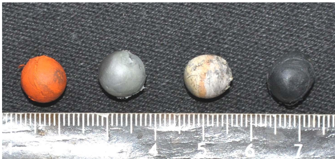
Рис. 6.11. Загальний вигляд досліджуваних стріляних куль, «Терен – 3 ФП», «Терен – 3» та «АЕ 9».
