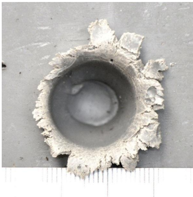
Рис. 4.7. Загальний вигляд утвореного пошкодження у блоці пластиліну при пострілах еластичним снарядом з дистанції 4 м.
