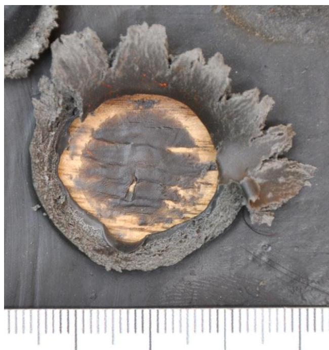
Рис. 4.2. Загальний вигляд утвореного пошкодження пластиліну при пострілі еластичним снарядом з дистанції 3 м
