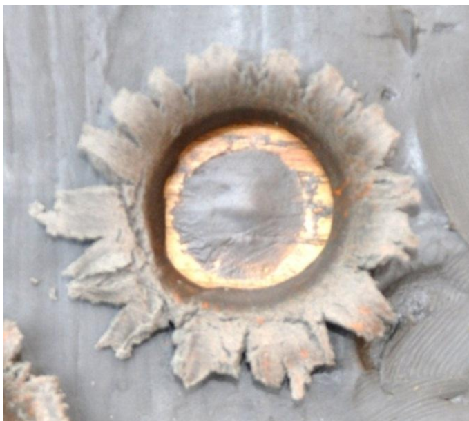
Рис. 4.3. Загальний вигляд утвореного пошкодження пластиліну при пострілі еластичним снарядом з дистанції 4 м
