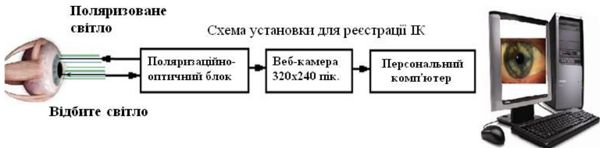
Рис. 2.2. Структурна схема установки для отримання зображень інтерференційних картин
