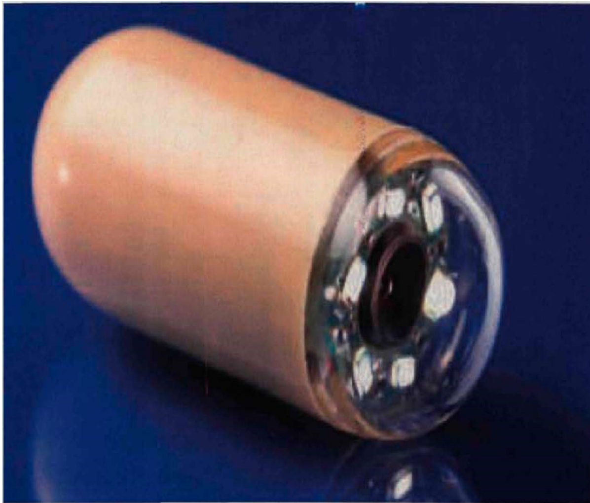
Рисунок 2.6. Загальний вигляд відеокапсули з 6 світлодіодами
