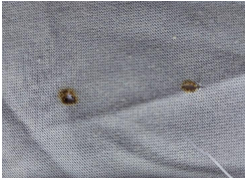
Рисунок 4.1. Загальний вигляд парно розташованих пошкоджень бавовняної тканини, спричинених електрошоковим пристроєм «WS-704»
