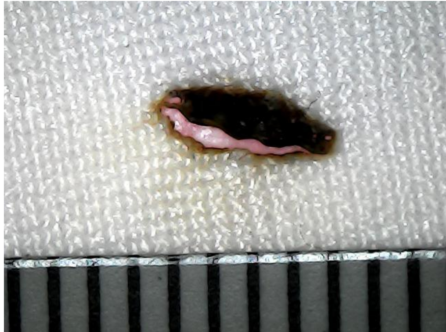
Рисунок 4.8. Пошкодження синтетичної тканини – поліестеру (80%) з еластаном, при перпендикулярній дії контактного електроду електрошокового пристрою «WS-704»
