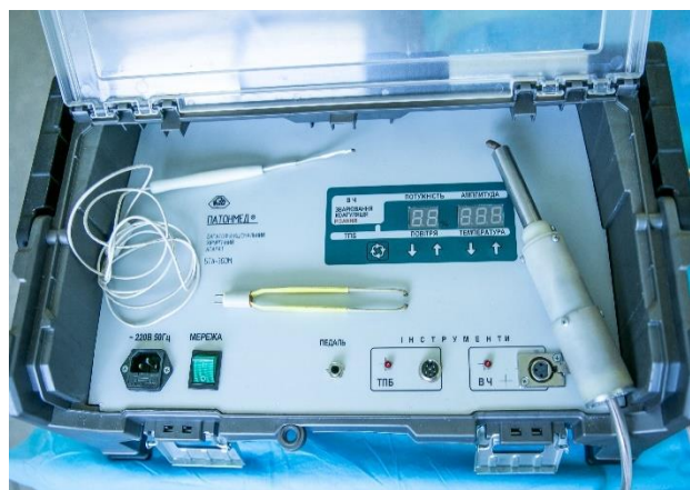
Рис. 3.2. Зовнішній вигляд апарату для високочастотного електрозварювання БТА-300М «ПАТОНМЕД®» з можливістю конвекційно-інфрачервоної (термоструминної) коагуляції.
